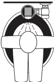
3. Cuando el usuario se retira del Sensor SOLIS®, el Sensor inicia una señal eléctrica que opera la Solenoide. Esto inicia el ciclo de descarga para enjuagar el accesorio. El Circuito entonces se restablece automáticamente y está listo para el siguiente usuario.
