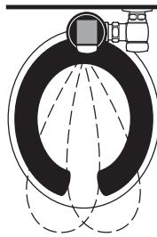
2. Al entrar el usuario al rango efectivo del haz (15" a 30") éste se refleja en la Ventana del Escáner SOLIS® y se transforma en un circuito eléctrico de bajo voltaje. Una vez activado, el Circuito de Salida continúa en modo de "espera" mientras el usuario permanezca dentro del rango efectivo del Sensor.
